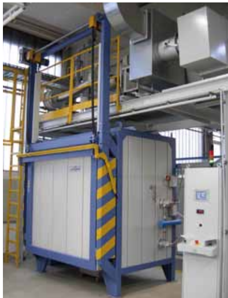
Gasbeheizter Kammerofen zum Entbindern und Sinter in einem Prozess, mit thermischer Abluftreinigung
