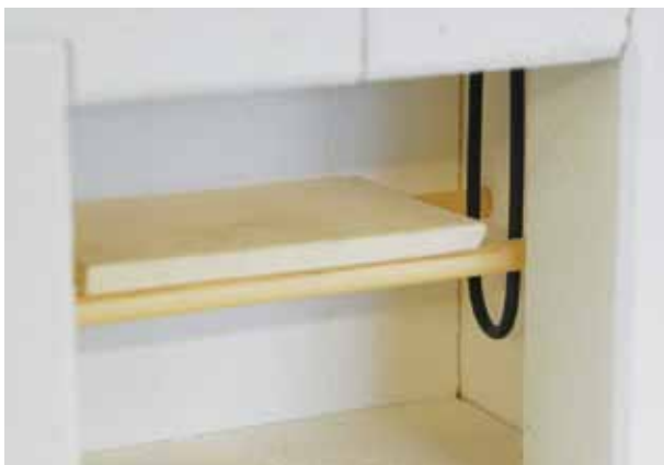
2. Beschickungsebene bei Ofen bis 1500 °C
