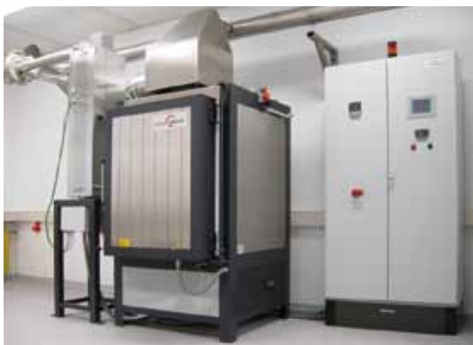
Kammerofen bis 1400 °C zum Entbindern und Sinter in einem Prozess, mit katalytischer Abluftreinigung
