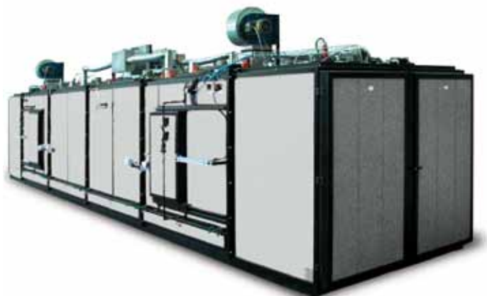
Hängebahn-Durchlaufofen DT 34000/02/AS Nutzmaße (mm): 2250 breit x 10000 tief x 1500 hoch; Bahnlänge 18 m Zum Aushärten von Verbundmaterialien Mit Absaugventilatoren zum Abführen von Dämpfen
