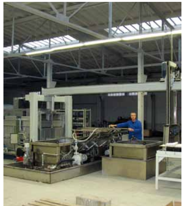
Integrierte Abschreck- und Reinigungs-bäder Doppelabschreckbad mit Umwälzung für unterschiedliche Abschreckmedien, automatisch verfahrbar, Bäder und Auffangwanne komplett aus Edelstahl, mit angeschlossenem Reinigungsbad und Ablagetisch
