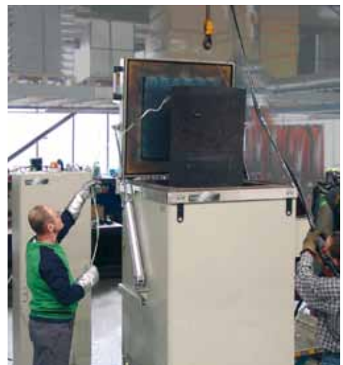
SU 380/06/VA · Ofen zum Glühen von Federn in Körben
