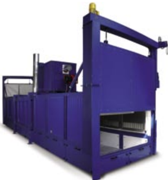
Gasbeheizter Durchlaufofen DT 12400/02 GAS Nutzmaße (mm): 2000 breit x 10300 tief x 600 hoch Zum Trocken von Gussformen
