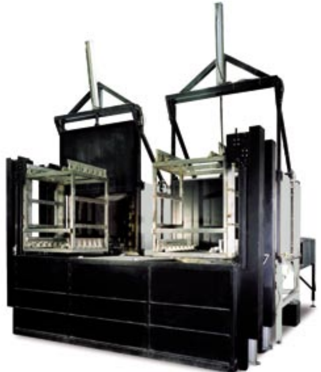
Halbautomatische Vergüteanlage auf Basis zweier Kammeröfen mit integrierten Abschreckbädern
