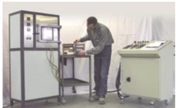
Überprüfung der Temperaturhomogenität mit geeichten Messinstrumenten nach zertifizierten Verfahren. Lieferung, Überholung und Modernisierung von Schaltanlagen
