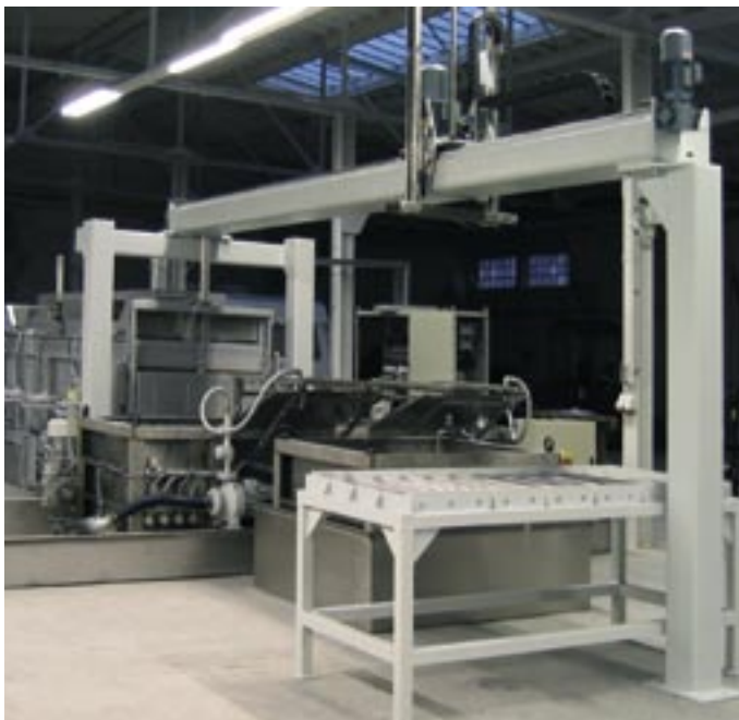
Vollautomatische Vergüteanlage auf Basis eines 4-Kammer-Durchlaufofens mit integrierter Abschreck- und Wascheinrichtung, vollautomatische Chargenzuführung und Chargentransport, professionelle Anlagensteuerung mit umfangreichen Dokumentationsmöglichkeiten
