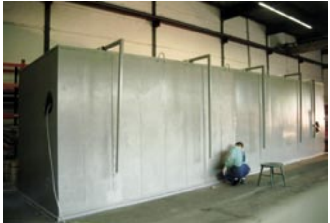
KT 36000/03/AS · Mehrkammertrockner, 36000 l Volumen
