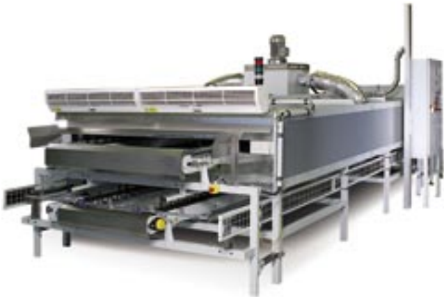
Durchlaufofen DT 4700/01/AS Nutzmaße (mm): 2500 breit x 4520 tief x 420 hoch Zum Aushärten von Dichtmasse an Kunststoffgehäusen. Mit Absaugventilatoren zum Abführen von Dämpfen
