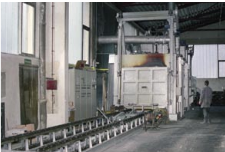
Durchlaufglühanlage · Mit Aufheiz-, Halte- und Kühlkammer
