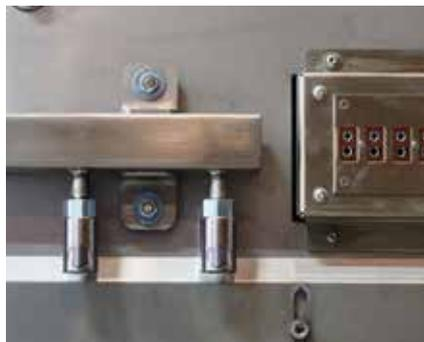
Anschlüsse für Vakuumpumpe und Chargen-Thermo-Elemente
