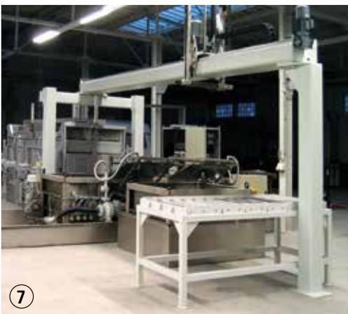
7 Linearförderer, hängender Betrieb, für die Manipulation von Chargierkörben.
