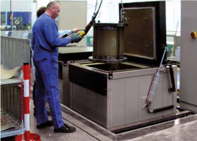
Modell SM 1000/06/HA bestehend aus 4 Schachtofen für die Wärmebehandlung von Maschinenteilen
