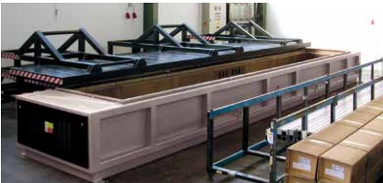
Modell SM 3000/04/HA Einkammer-Schachtofen für die Erwärmung von Aluminiumprofilen
