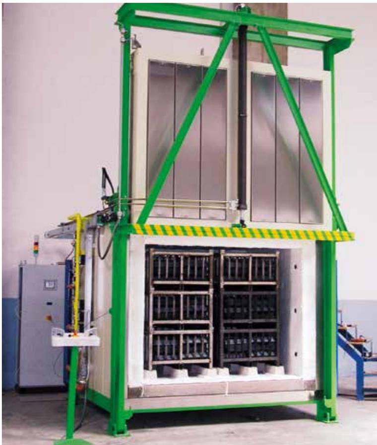
**Ofenanlage mit drei gasbeheizten Kammeröfen zur Wärmebehandlung von LKW-Dieselmotoren in Körben.**
