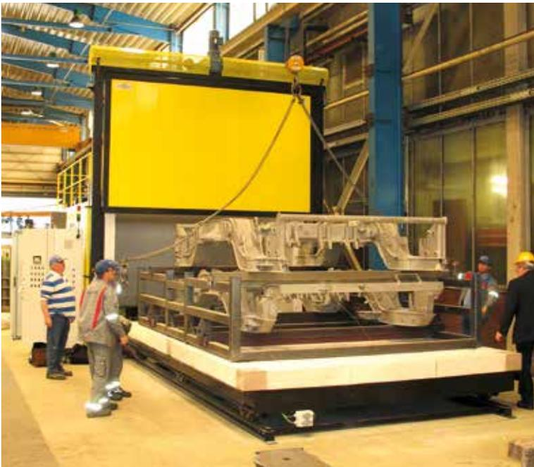
Gasbeheizter Herdwagenofen zum Spannungsarmglühen von Schweißkonstruktionen
