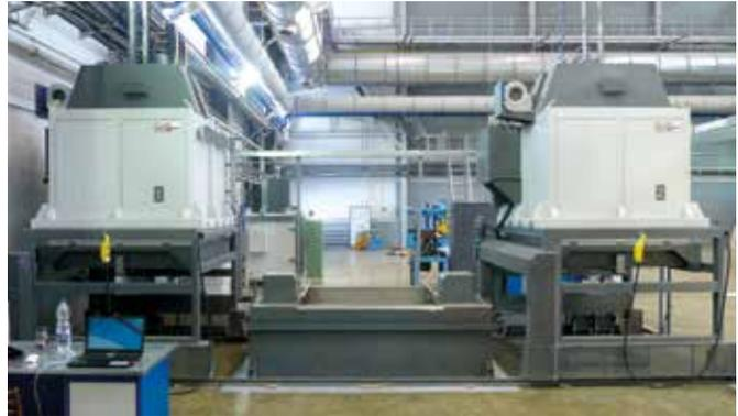
Vollautomatische Vergüteanlage für Al-Bauteile (Lösungsglühofen, Wasserbad, Auslagerungsöfen)
