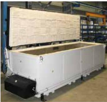
Schachtofen mit indirekter Gasbeheizung und horizontaler Umluftführung
