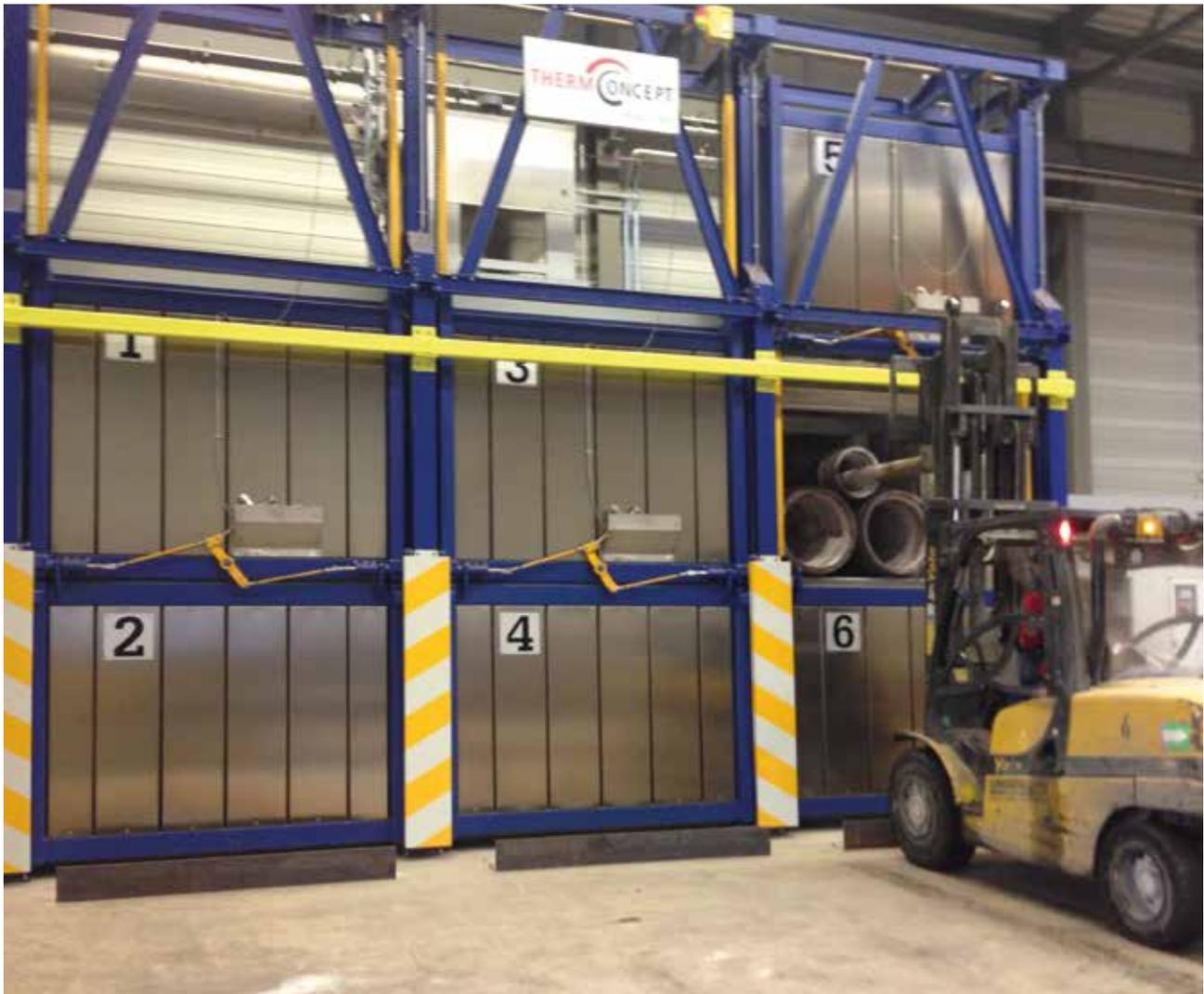
Zur Sicherstellung der Verfügbarkeit einer ausreichenden Zahl vorgewärmter Kokillen für die Gießanlagen werden bei 450 °C im Dauerbetrieb Kokillen für den Schleuderguss vorgewärmt.
