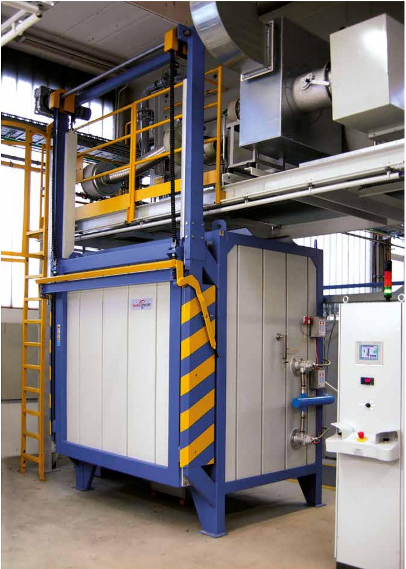
Gasbeheizter Kammerofen zum Wachsaußschmelzen von Turbinenschaufeln mit integrierter thermischer Nachverbrennung
