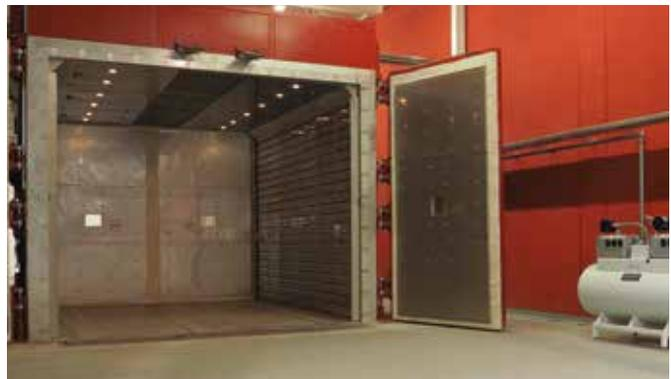
Elektrisch beheizte Ofenanlage (Vol. 84 m<sup>3</sup>) zum Tempern von Strukturbauteilen für Schienenfahrzeuge aus innovativen Compositen in Vakuumsäcken
