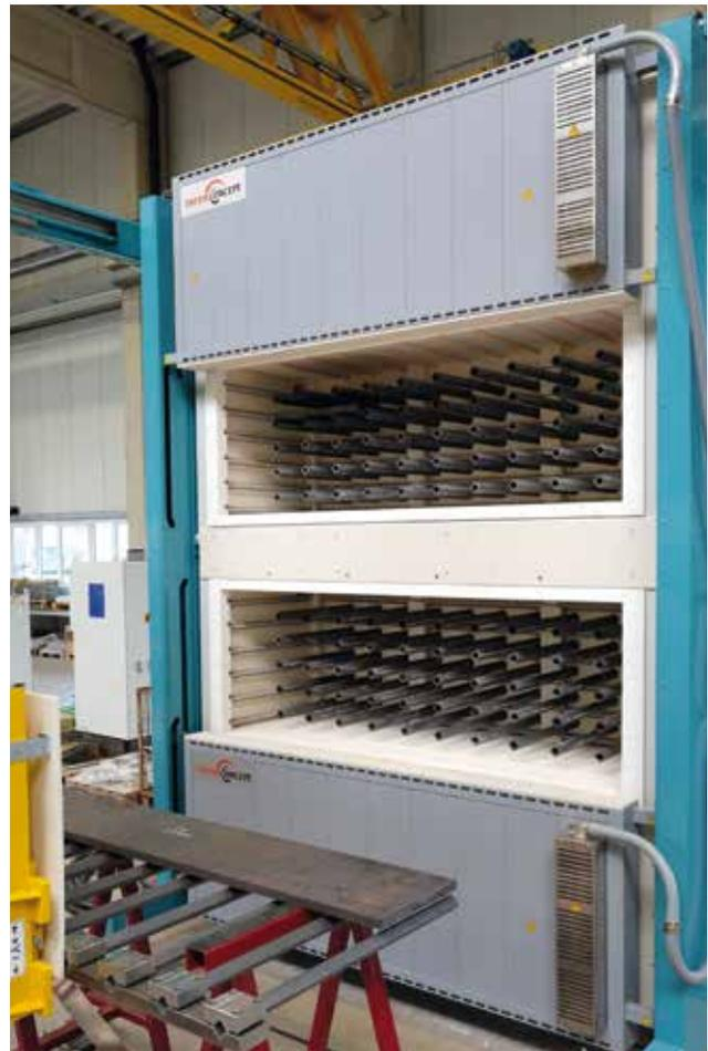
Kammeröfen mit 5 Ebenen für die Ablage der Bleche zum Homogenisieren und Kühlen.
