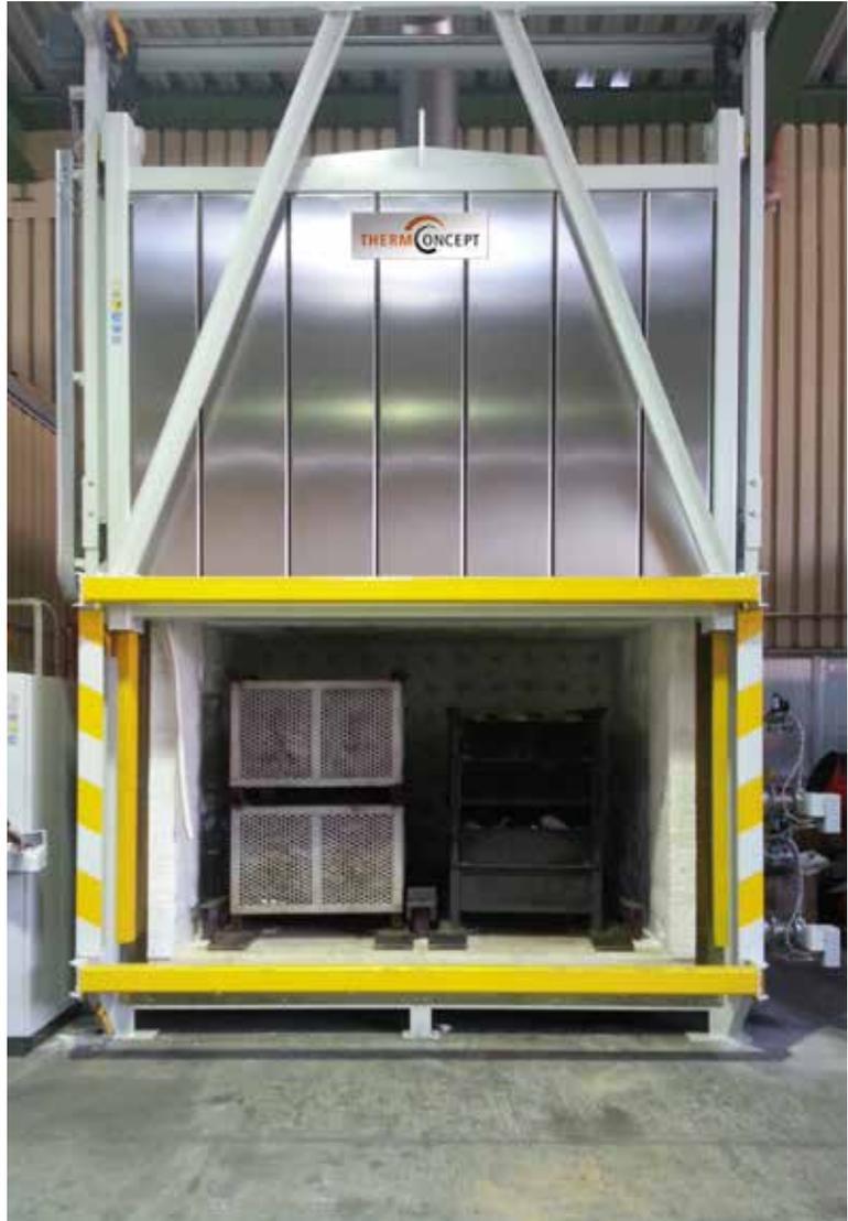
Produktionsanlage bestehend aus zwei identischen gasbeheizten Herdwagenöfen für T max. 1200 °C. Die Öfen sind mit jeweils 8 Rekuperator-Gasbrennern ausgestattet. Die Temperaturregelung ist mehrzonig ausgelegt. Die Abgasnachbehandlung erfolgt über eine leistungsstarke thermische Nachverbrennung. Darüber hinaus verfügen die Öfen über eine geregelte Chargenkühlung.
