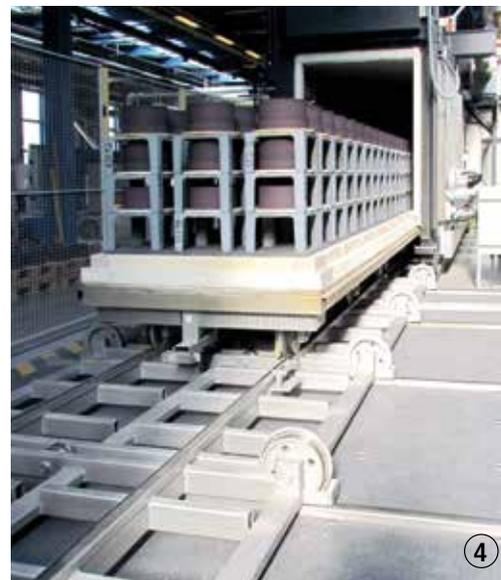
5+6 Linearförderer, schienengebunden, mit pneumatischer Hubeinrichtung für die Chargierung großformatiger Bleche.
