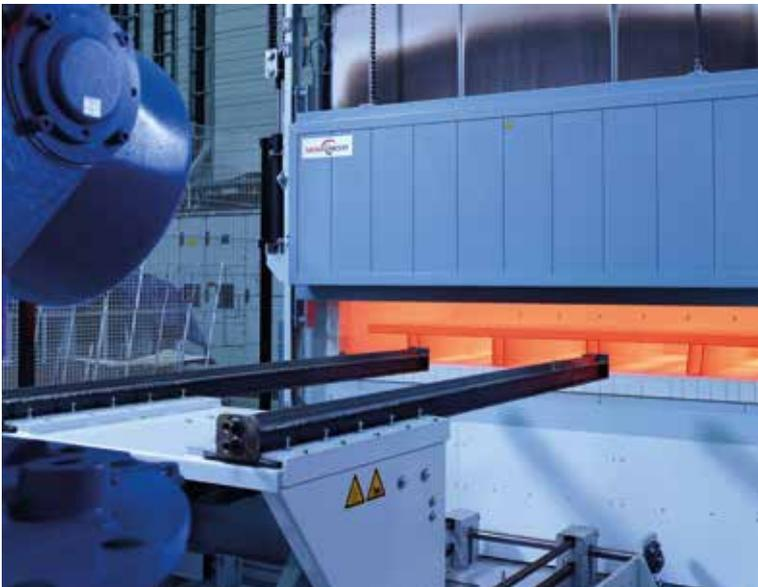
Platinenvorwärmofen mit robotergestützter Chargierung
