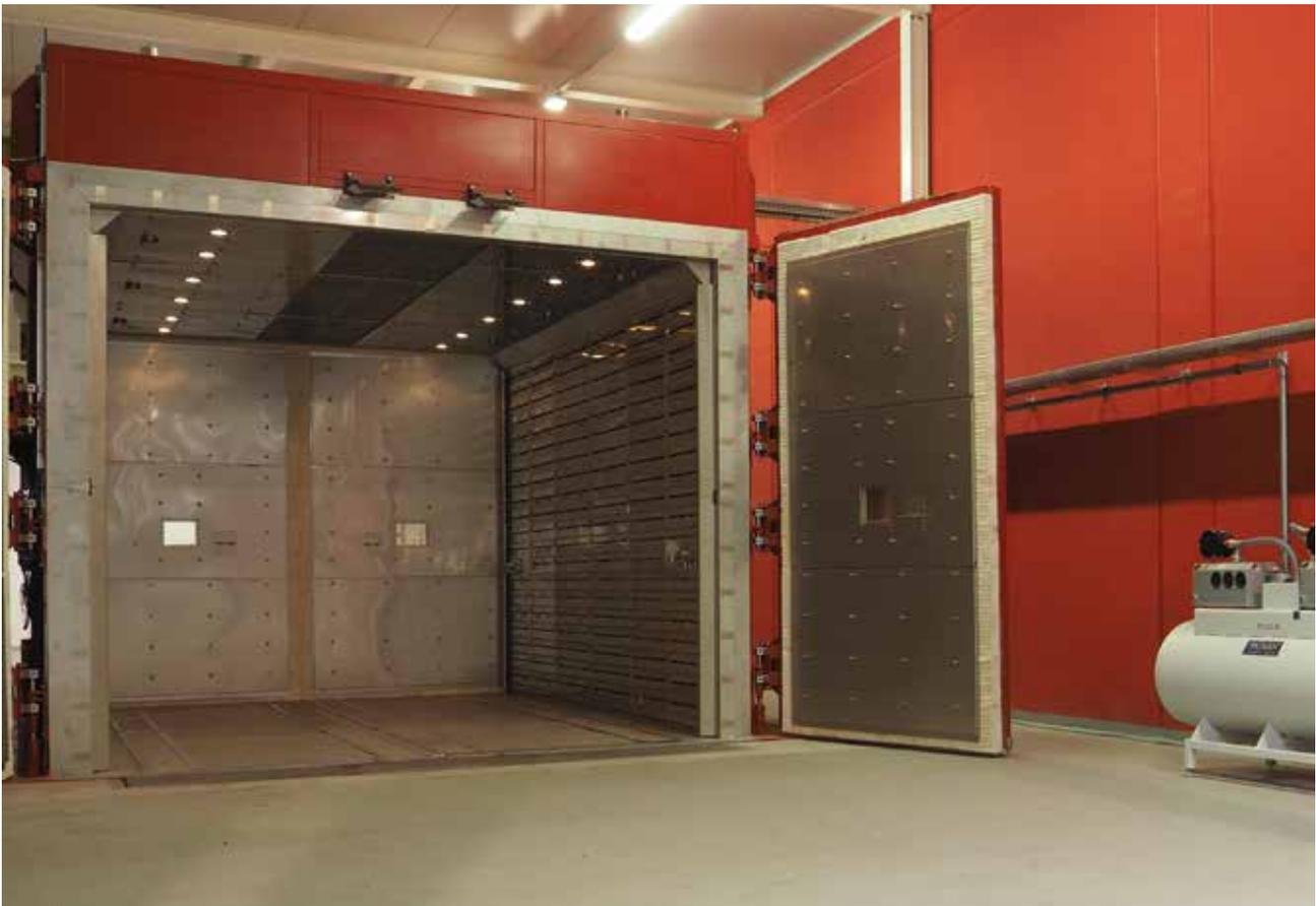
KT 84000/02/AS Elektrisch beheizte Ofenanlage für das Tempern in Vakuum von Strukturbauteilen für Schienenfahrzeuge aus innovativen Compositen
