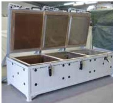
Schachtofen mit 3 separat regelbaren Kammern für das Vorwärmen von Stahlwalzen
