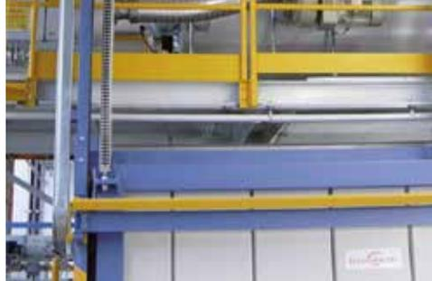
Gasbeheizte Ofenanlage zum Wachs ausschmelzen mit thermischer Nachverbrennung, Programmablaufsteuerung und Temperaturregelung über eine Siemens SPS S7 mit Touch-Panel.
