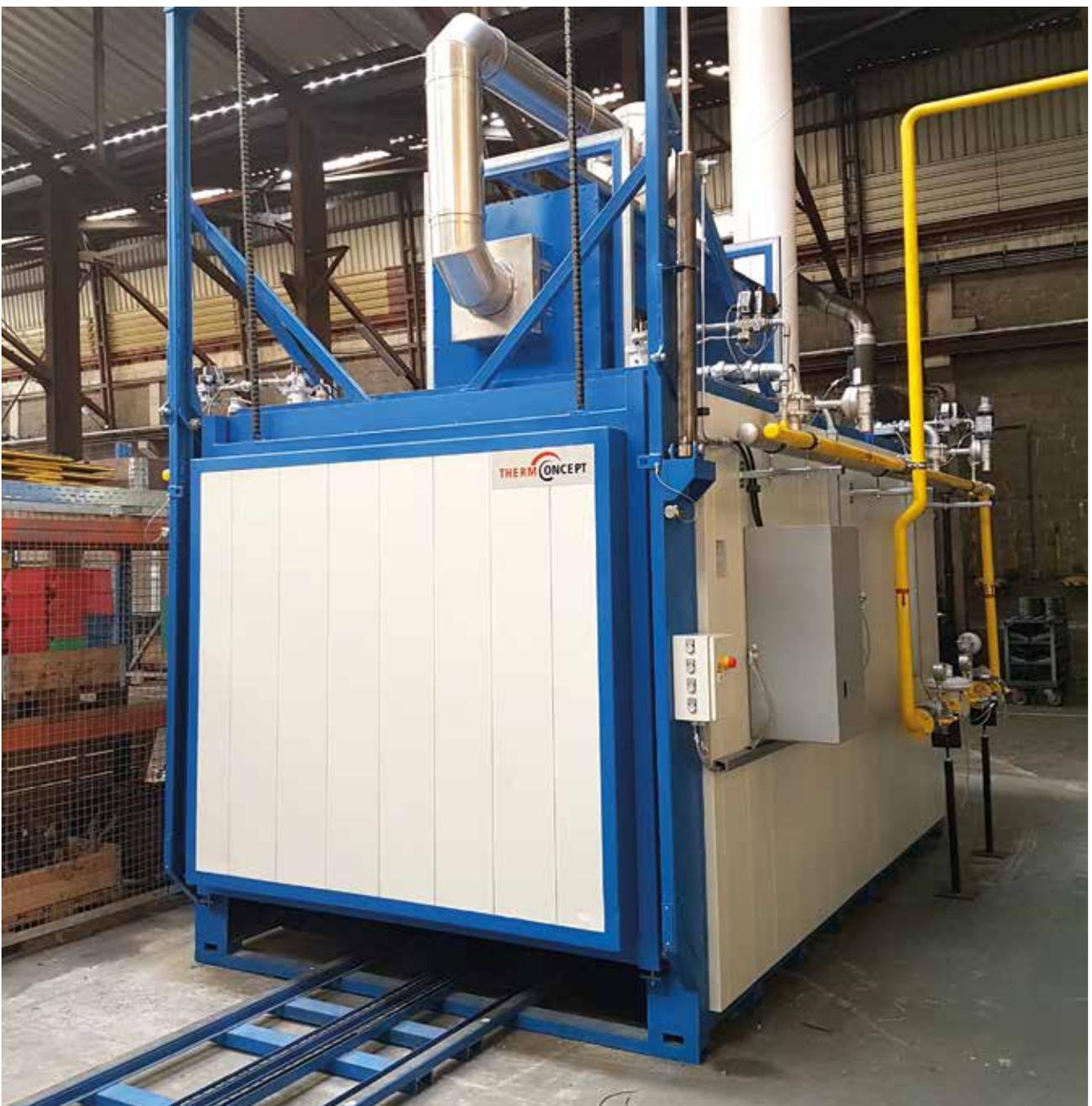
Gasbeheizter Herdswagenofen mit integrierter thermischer Nachverbrennung
