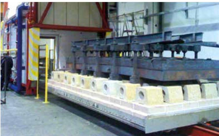
Herdwagenofen zum Spannungsarmglühen von Blechen für hochbeanspruchte Präzisionsteile wie Press- und Trägerbleche, Stanzplatten und Presswerkzeuge.
