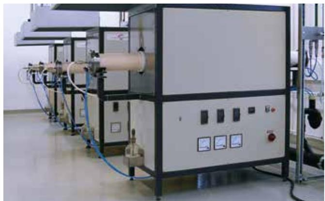
Produktionsanlage bestehend aus 4 Hochtemperatur-Rohröfen für das Entbindern und Sintern von Keramiken nach dem 3D-Druck
