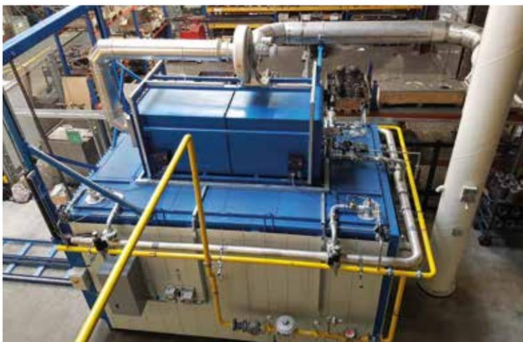
THERMCONCEPT liefert integrierte Anlagensysteme, bestehend aus der Ofenanlage, der katalytischen Abluftreinigung und einer SPS-Gesamtprozesssteuerung. Das Anlagensystem beinhaltet auch die erforderliche Sicherheitstechnik nach EN 1539. Auf Wunsch werden die Anlagen mit einer angepassten Abgasverrohrung geliefert.
