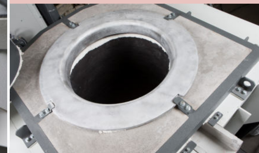
Bild rechts: Ausgussnase im der Kippachse für exakten Gießstrahl Bild unten: Gussring zum Schutz des Tiegelrandes
