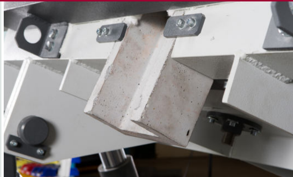
Bild rechts: Ausgussnase im der Kippachse für exakten Gießstrahl Bild unten: Gussring zum Schutz des Tiegelrandes
