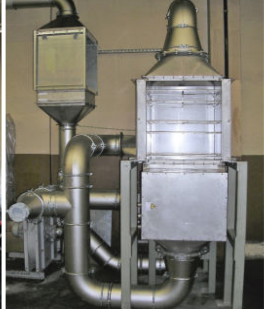
Bilder links: Katalytische Abluftanlage, individuell für prozessspezifische Abgasmengen und -bestandteile ausgelegt
