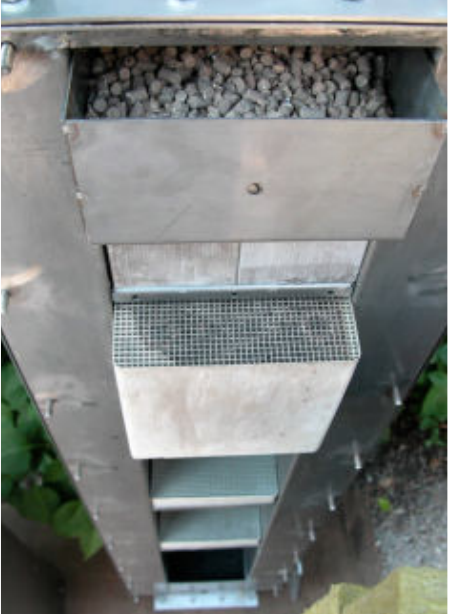
Bilder rechts: Größerer Standard-Katalysator mit unterschiedlichen Reinigungsstufen über Waben und Schüttungen sowie Heizregistern
