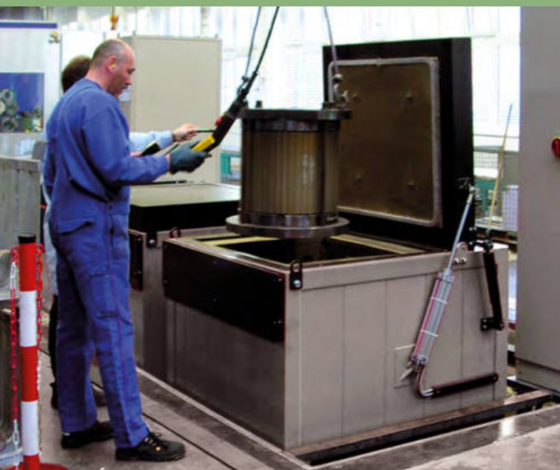
Produktionsanlage bestehend aus 4 Truhenöfen für das Trocknen und Einbrennen von Lacken
