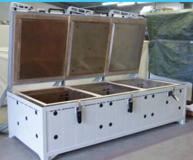
Truhenofen mit 3 separat regelbaren Kammern für das Vorwärmen von Bauteilen zum Aufschrumpfen
