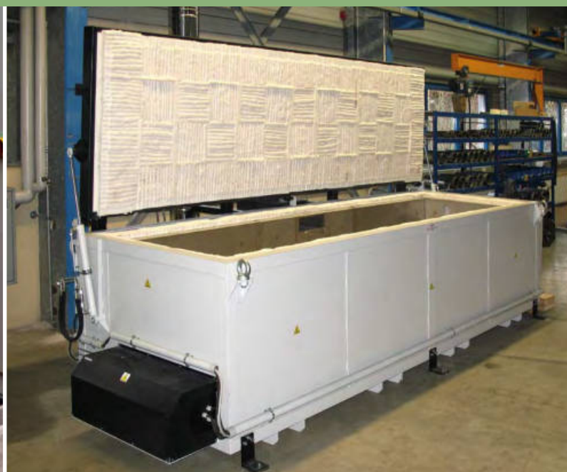
Indirekt gasbeheizter Truhenofen mit horizontaler Luftführung für das Tempern von kunststoffbeschichteten Walzen für die Papierherstellung
