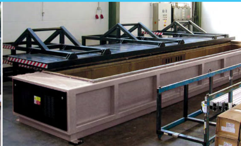
Einkammer-Schachtofen zum Vorwärmen von Aluminiumprofilen vor dem Biegen
