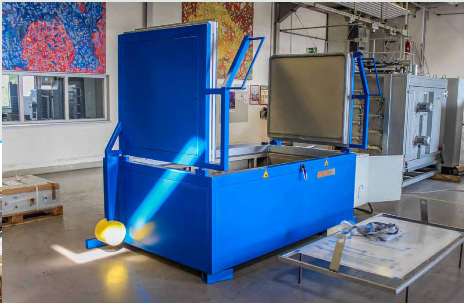
Indirekt gasbeheizter Truhenofen mit horizontaler Luftführung für das Tempern von kunststoffbeschichteten Walzen für die Papierherstellung
