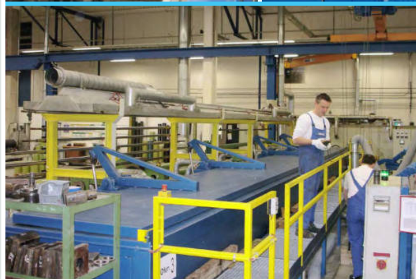
Absauganlage an einem Truhenofen
