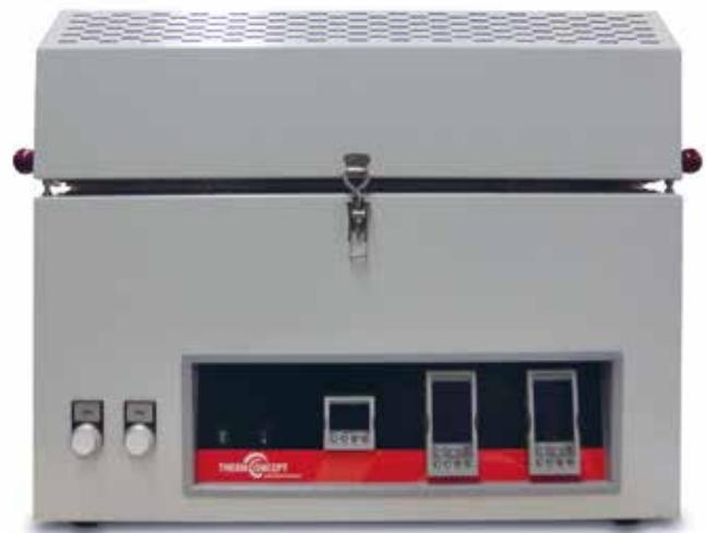
Klapp-Rohröfen mit 2 unabhängigen Regelzonen für den thermischen Transport
