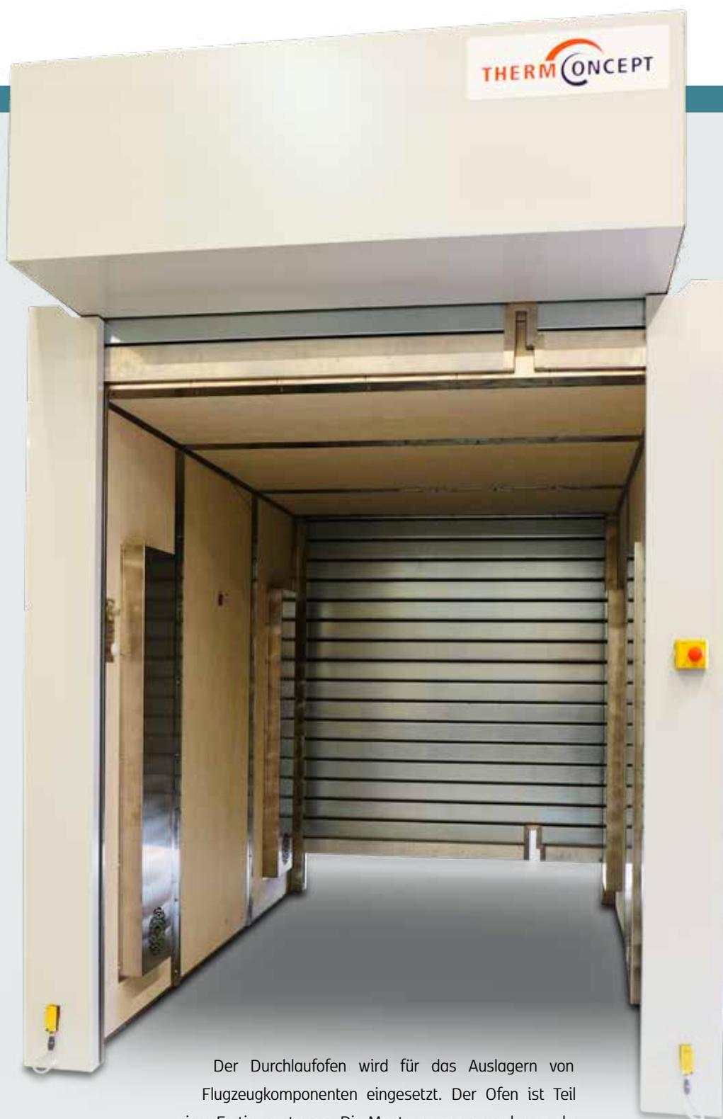
Der Durchlaufofen wird für das Auslagern von Flugzeugkomponenten eingesetzt. Der Ofen ist Teil einer Fertigungsstraße. Die Montagewagen werden an der hinteren Ofenseite über eine Transporteinrichtung in den Ofen geführt. Nach Abschluss der Wärmebehandlung fahren die Montagewagen an der Frontseite aus dem Ofen heraus zur Weiterbearbeitung. Die Ofenanlage verfügt über platzsparende Rolltore.
