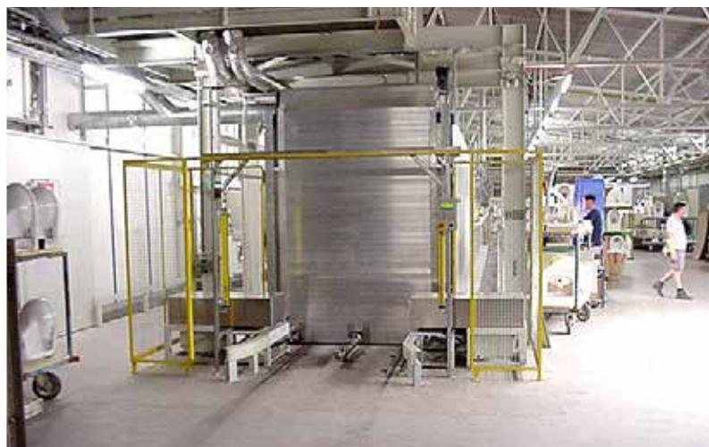
Durchlaufofen mit einer Länge von 20 m zum Auslagern. Die Bauteile sind auf Einfahrwagen positioniert. Der Antrieb der Chargenwagen erfolgt über eine Kette.
