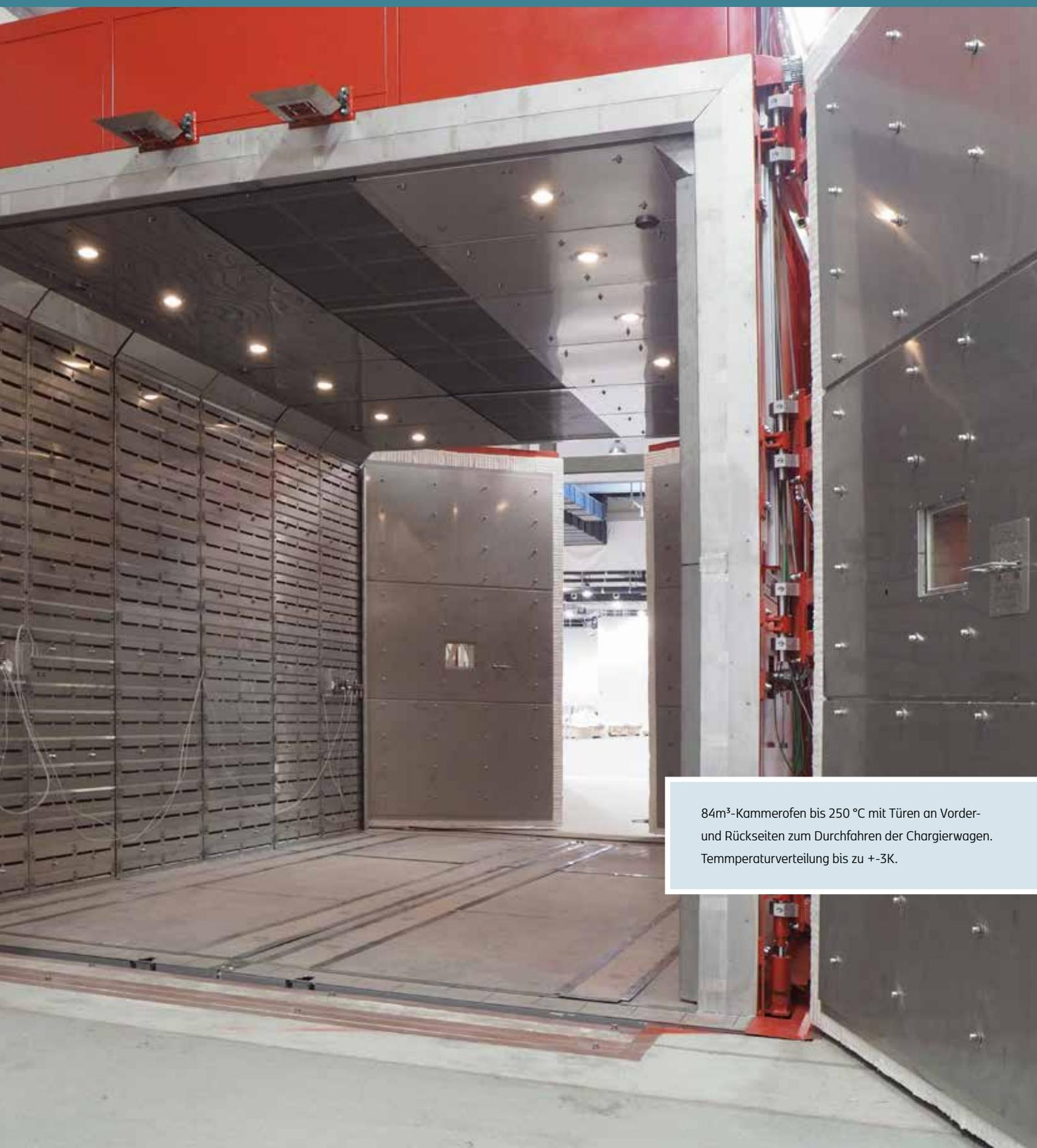
84m<sup>3</sup>-Kammerofen bis 250 °C mit Türen an Vorder- und Rückseiten zum Durchfahren der Chargierwagen. Temperaturverteilung bis zu +-3K.
