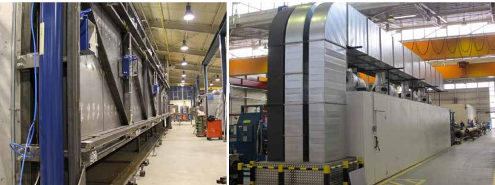
Ofenanlage für Walzen mit einer Länge von bis zu 14.500 mm.
