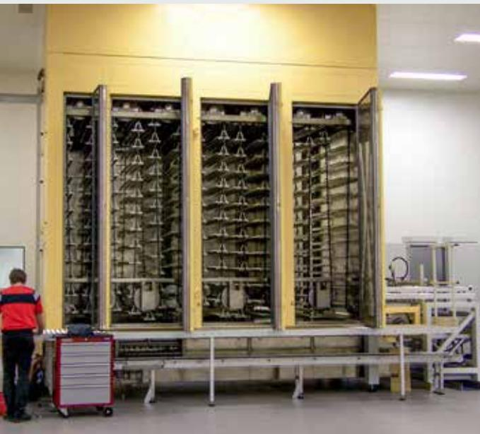
Diese Gondel-Paternosteranlagen sind komplett in eine Automation integriert. 18 Öfen laufen 24/7 mit nur einer einwöchigen Wartungsunterbrechung pro Jahr.
