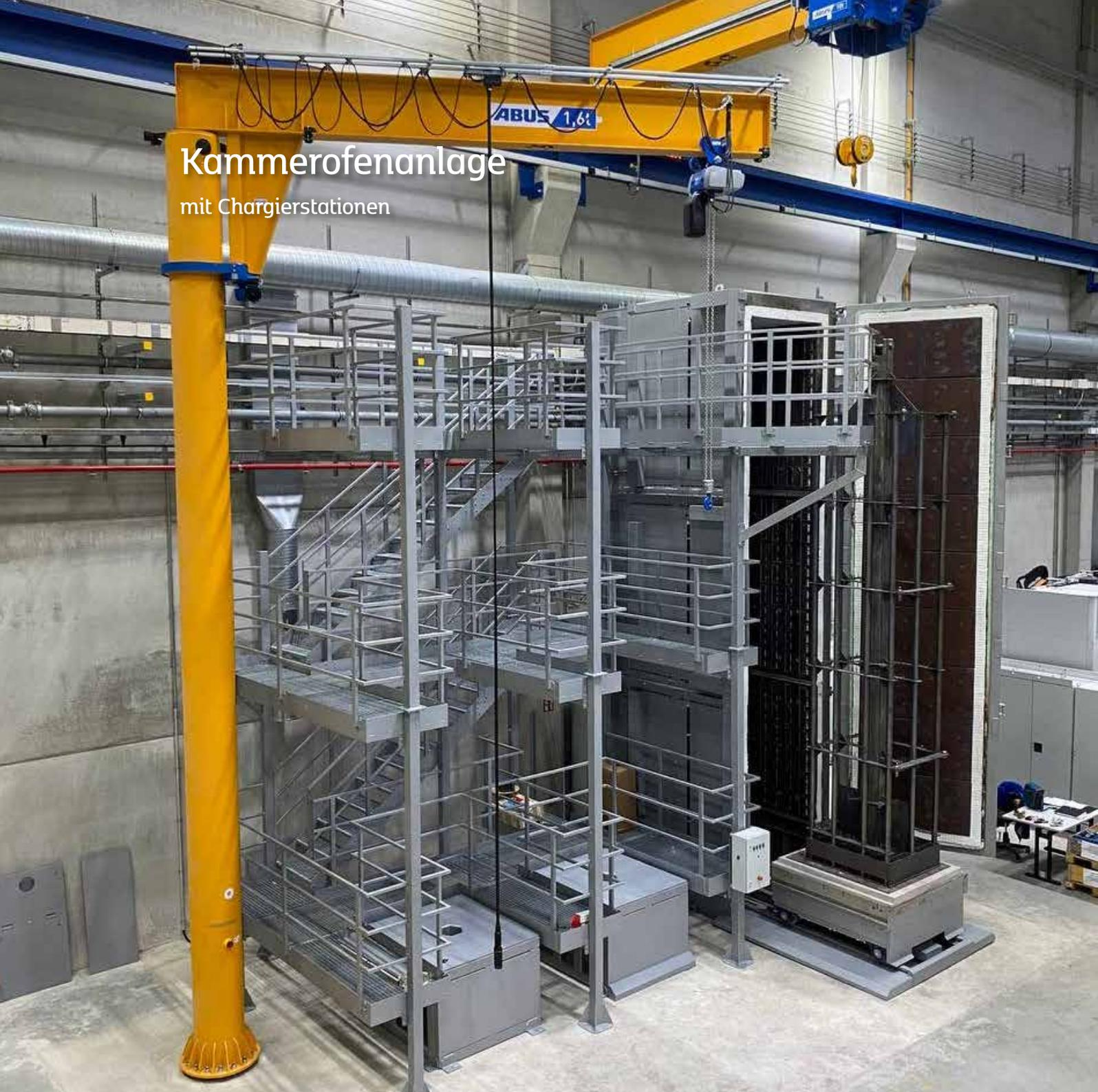
Sonderanlage bestehend aus einem Kammerofen mit herausfahbarem Boden in einer Höhe von 6,2 m und einer Grundfläche von 1,2 m x 1,4 m für Temperaturen bis 700°C und 2 Bereitstellungsplätze mit Arbeitsbühne.
