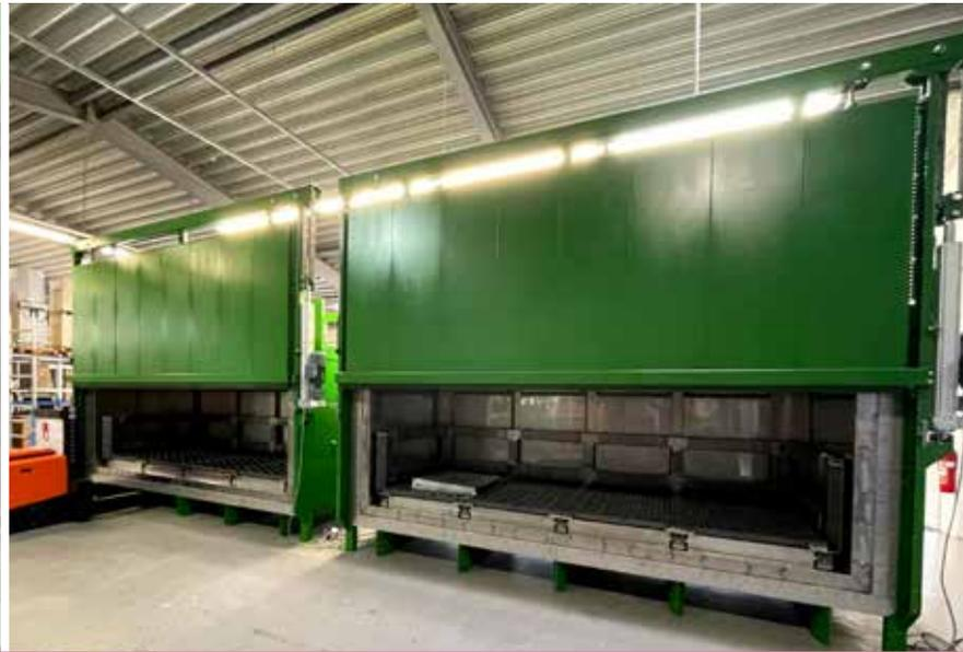
Elektrisch beheizter Umluft-Doppelkammerofen mit Innenabmessungen von je 3680 x 1700 x 1200 mm für max. 650°C.
