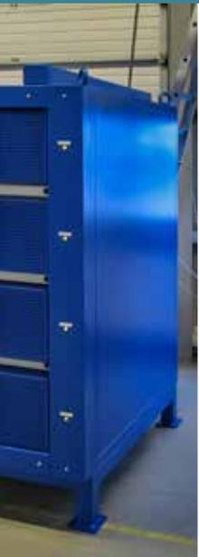
Öfen jeweils mit doppel­flügeligen Türen für unabhängige Zeitabläufe bei gemeinsamer Beheizung und Umluft. Zur einfachen Beschickung mit herauszieh­barem Beschickungs­boden
