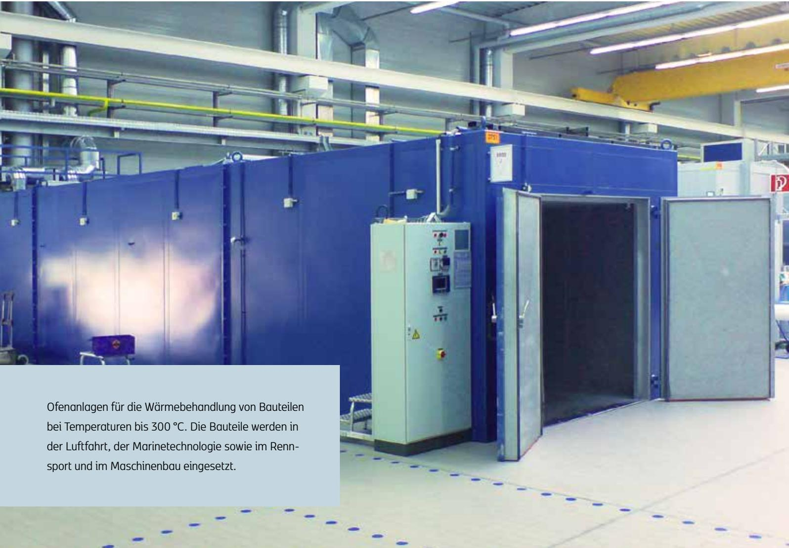
Ofenanlagen für die Wärmebehandlung von Bauteilen bei Temperaturen bis 300 °C. Die Bauteile werden in der Luftfahrt, der Marinetechologie sowie im Rennsport und im Maschinenbau eingesetzt.
