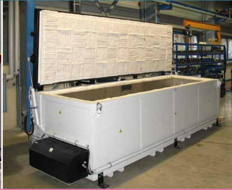
Indirekt gasbeheizter Truhenofen mit horizontaler Luftführung für das Tempern von Walzen für die Papierherstellung
